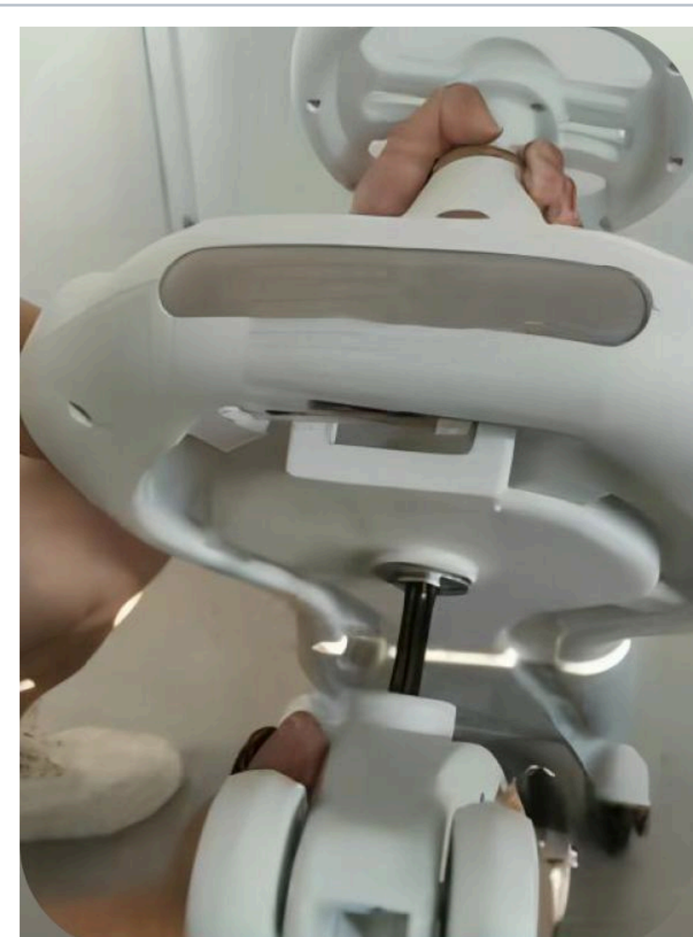
5. Проденьте рулевой треугольник через рулевой вал.
