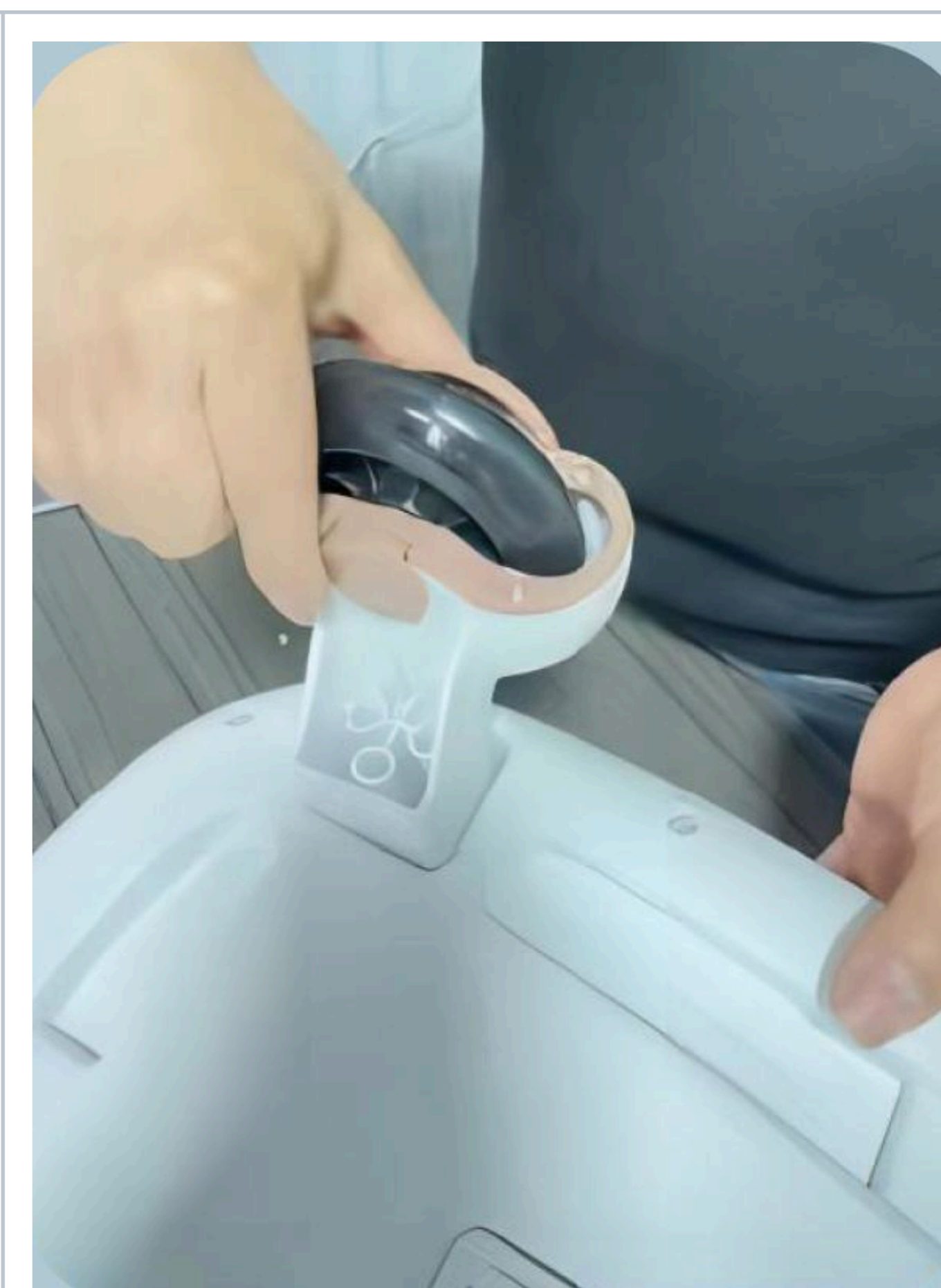
4. Вставьте колесо в заднюю секцию толокара и прижмите его к основанию, закрутив его на шурупы с помощью отвертки.
